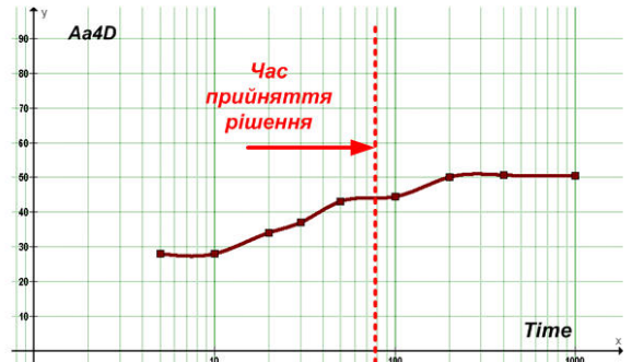
Рисунок 4 – Аперттура аттрактора залежно від часу вимірювання для 1% відміни біфуркаційних параметрів та SNR=1дБ
