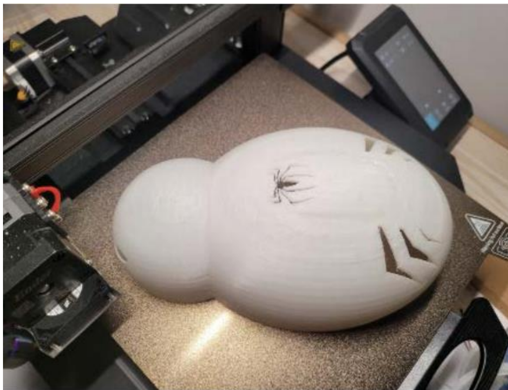
Рисунок 2.4 – Загальний вигляд процесу 3D-друку корпусу МРГ
