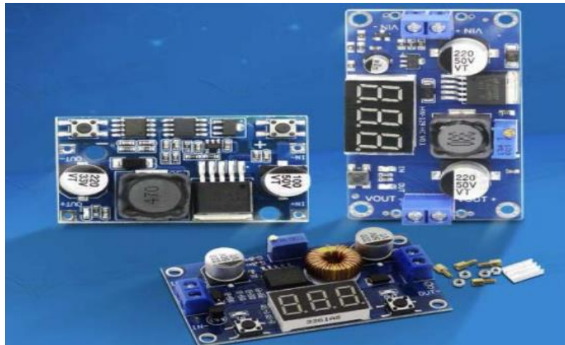
Рисунок 3.18 – Загальний вигляд понижуючого і стабілізуючого джерела живлення постійної сили струму типу DC-DC – LM2596S [58, 59]
