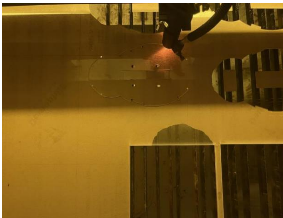
Рисунок 2.5 – Загальний вигляд процесу лазерної різки нижньої пластини корпусу МРГ
