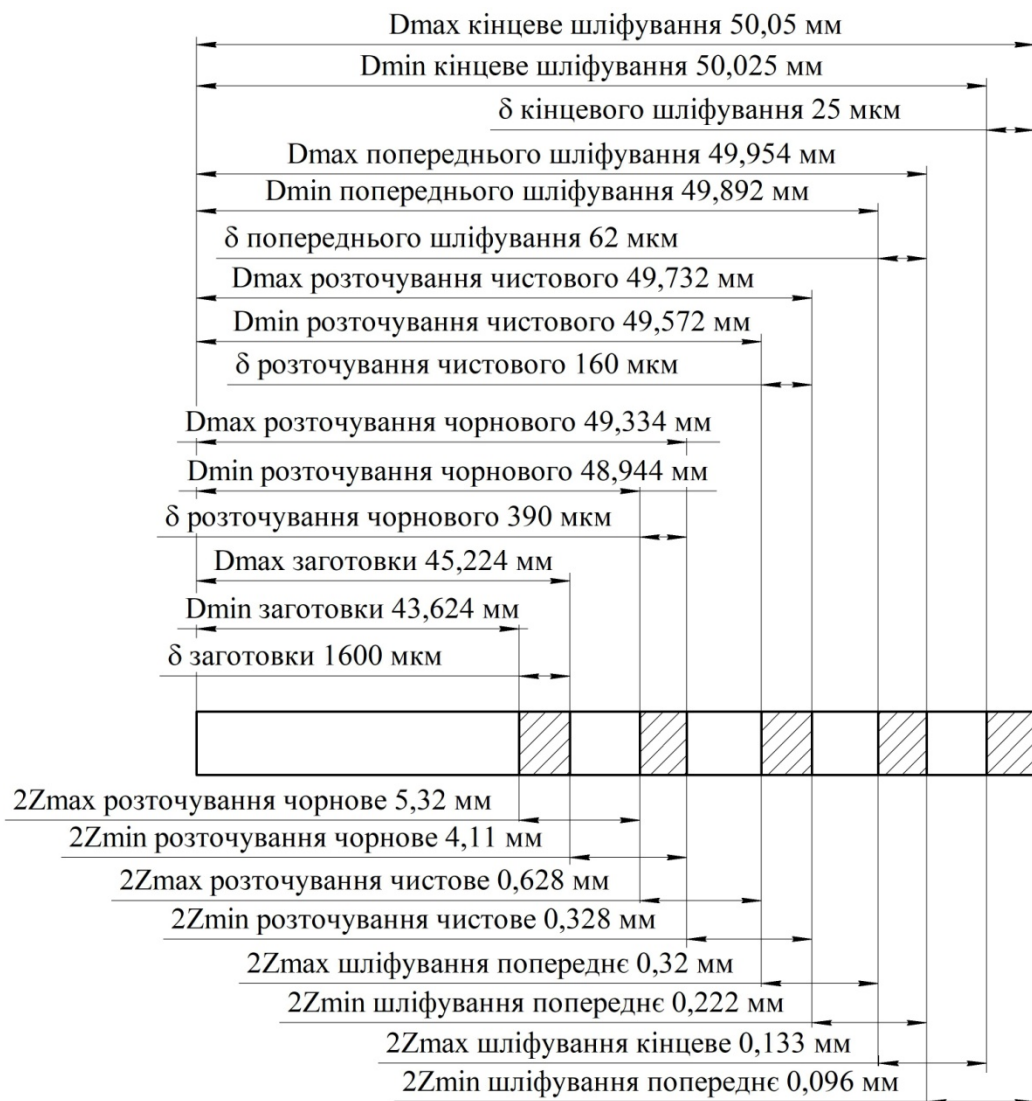
Рисунок 2.1 – Схема графічного розташування припусків та допусків на обробку отвору \text{Ø}50\text{F}7 шестерні
