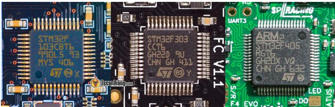
Рис. 1. STM32 F1, F3, F4 в польотних контролерах
