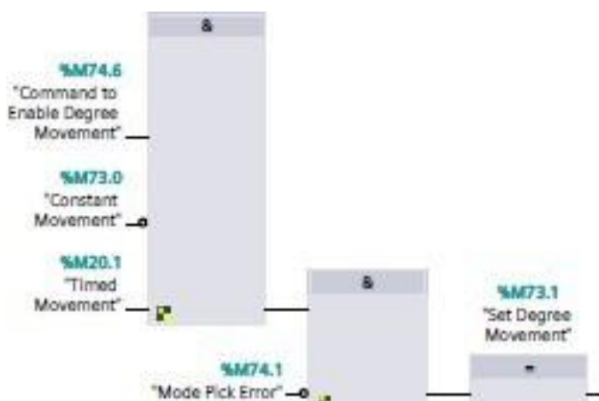
Рисунок 3.14 – Команда переміщення двигуна на заданий кут
