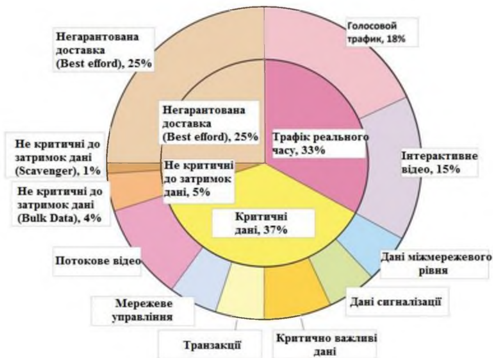
Рисунок 1.4 - Структура сучасного мережевого та інформаційного потоку із точки зору її складу сервісних потоків та її додатків
