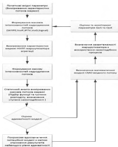
Рисунок 3.11 - Блок схема алгоритму роботи моделі для обслуговування вхідного її навантаження та визначення усіх характеристик потоків даних
