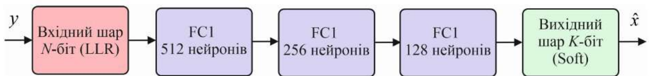
Рисунок 3.2 – Блок схема декодера LDPC-коду яка відповідає архітектурі DNN-декодера
