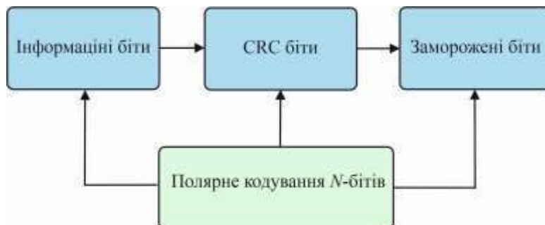
Рис. 10. Схема формування полярного коду з CRC
