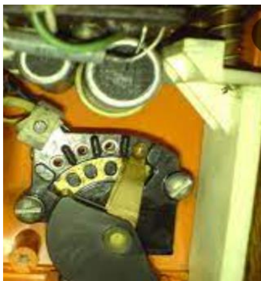
Рисунок 1.7 – Пристрій регулювання 5 швидкостей обертання насадок та схема його підключення до двигуна
