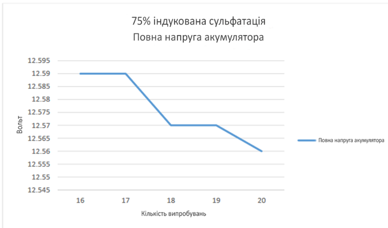
Рисунок 3.14 – Повна напруга акумулятора при 75% індукованої сульфатації
