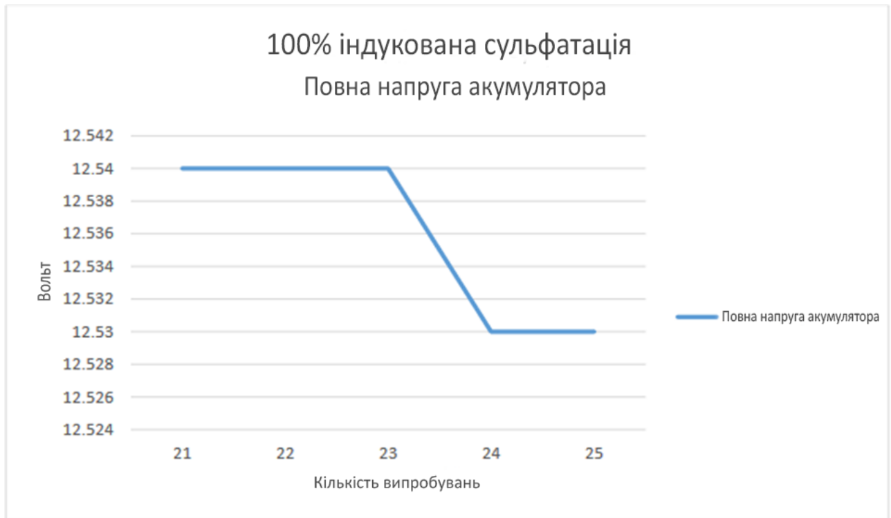
Рисунок 3.16 – Повна напруга акумулятора при 100% індукованої сульфатації
