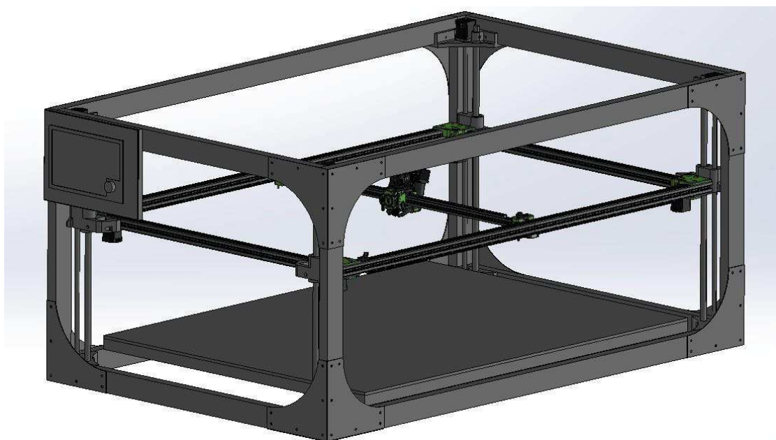
Рисунок 2.10 – Модель принтера розроблена у CAD програмі
