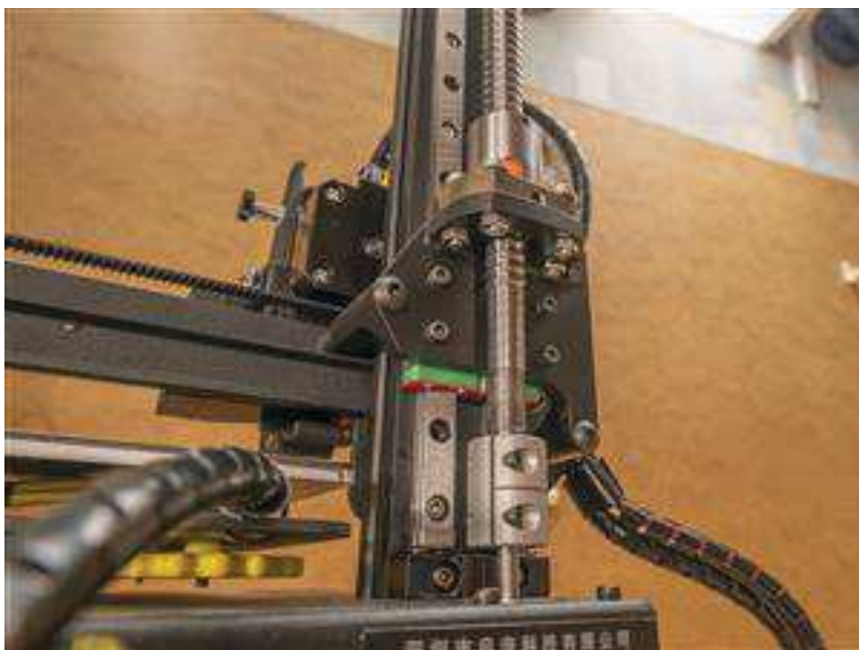
Рисунок 2.4 – Конструкція, що забезпечує рух друкуючої головки вздовж осі Z
