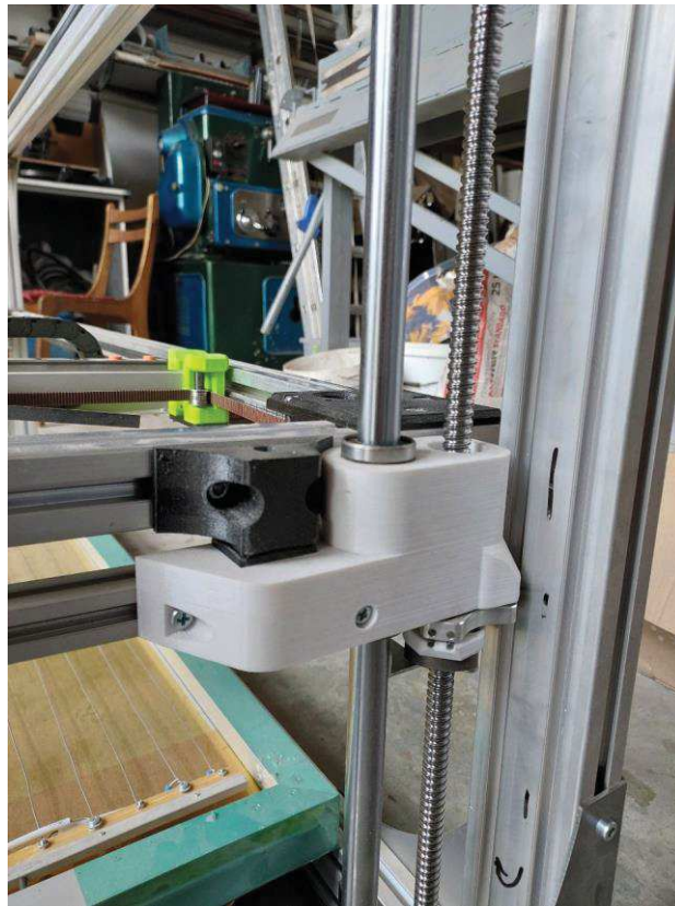
Рисунок 2.17 – Реалізація механізму переміщення осі Z
