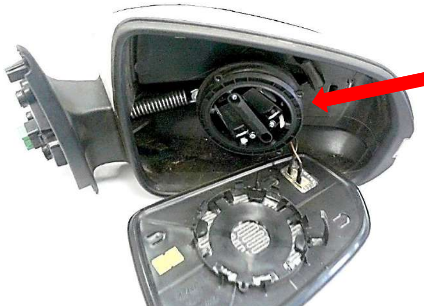
Рисунок 29 – Моторедуктор дзеркального елемента 7.2.Практичне виявлення дефекту дзеркала
