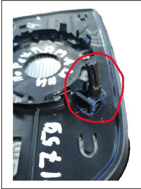
Рисунок 35 - Доопрацьована демпфуюча лапка дзеркального елемента
