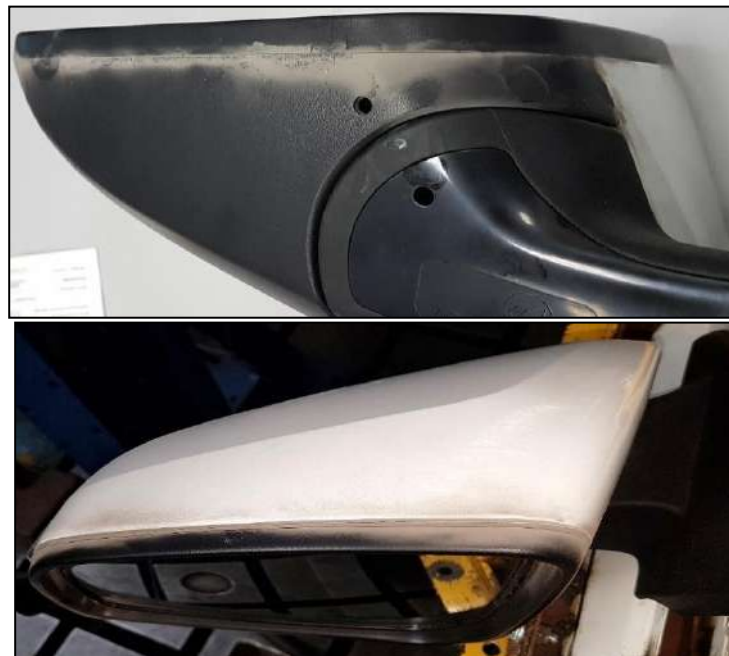
Рисунок 13 – Пластиковий пил на поверхні дзеркала
