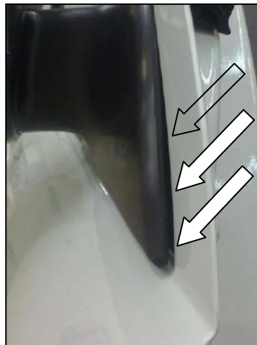
Рисунок 10 – Неприлягання до поверхні
