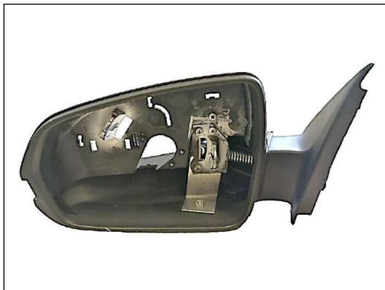
Рисунок 34 – Додавання 2 опори під лапку, що демпфує
