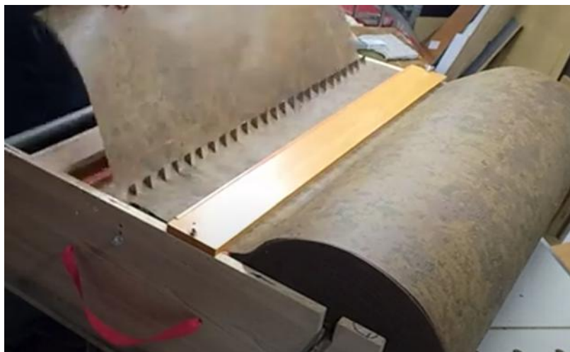
Рисунок 1.1 - Метод розкрою рулонного матеріалу на тонкі стрічки за допомогою ножів
