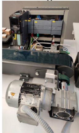
Рис.1. Загальний вигляд стрічки конвеєру разом із частотним перетворювачем Sinamic G120 та двигуном
