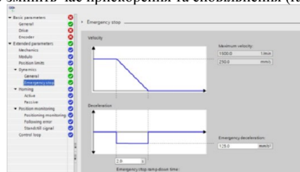
Рис. 10. Налаштування параметра Аварійна зупинка для асинхронного двигуна стрічки конвеєра
