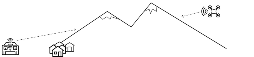
Рисунок 1.1 – Радіозв'язок не може бути встановлений, якщо лінія видимості закрита масивними об'єктами
