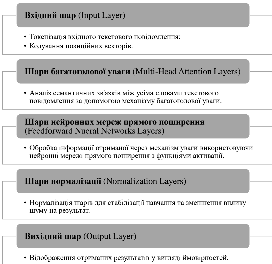
Рисунок 2.3 – Типи шарів багатомовної моделі глибокого навчання BERT
