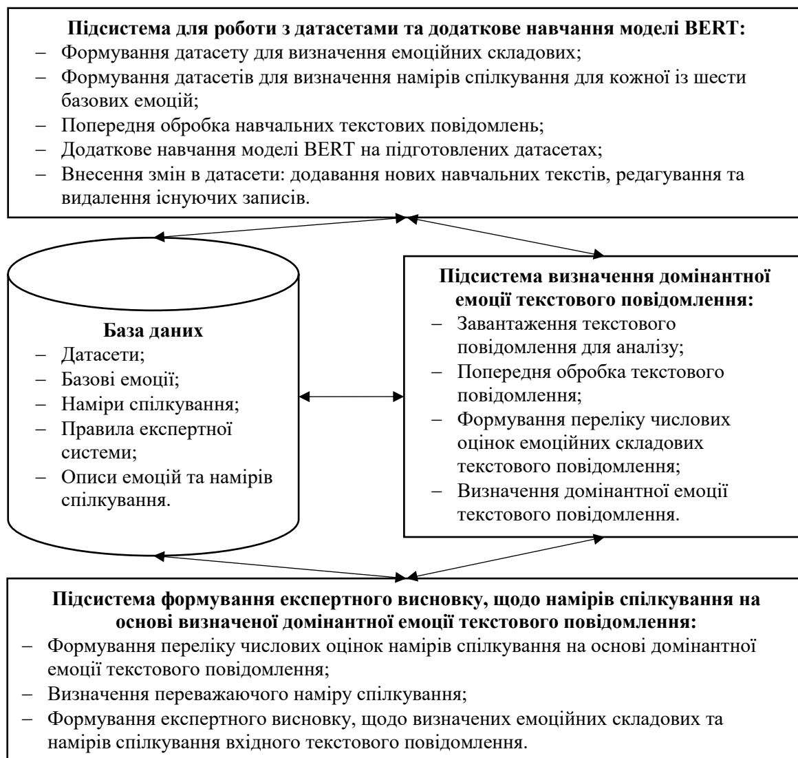
Рисунок 3.2 – Схема структури інформаційної системи для визначення емоційних складових та намірів спілкування за текстовими повідомленнями
