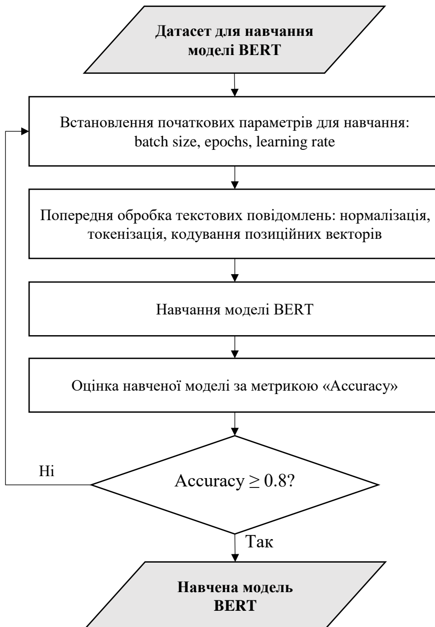
Рисунок 2.2 – Схема процесу навчання моделі BERT
