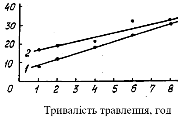
Рисунок 4.13 – Відносна втрата пружності поршневими кільцями: 1 – розрахунковий графік; 2 – експериментальні дані
