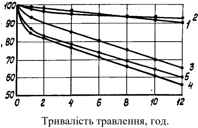
Рисунок 4.12 – Вплив корозійного середовища на пружність поршневих кілець: 1 – 5 – номери партій кілець (див. табл. 4.8)
