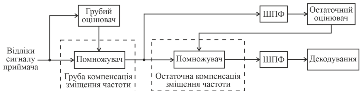
Рисунок 4.1 – Схема оцінки та компенсації зміщення частоти носійної
