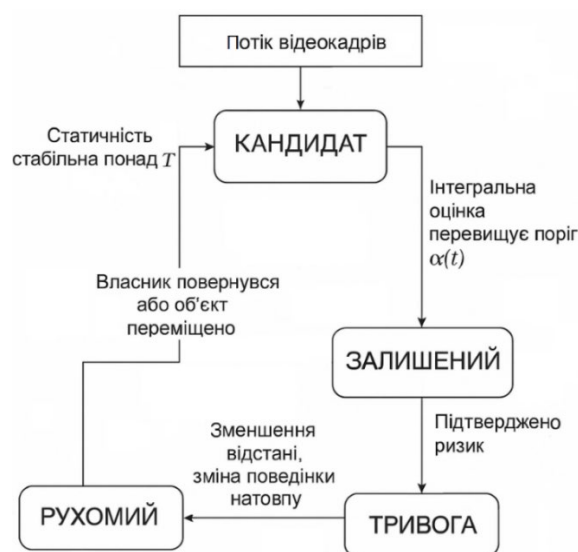
Рисунок 3.3 – Життєвий цикл об'єкта та умови переходів між станами
