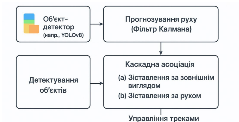
Рисунок 1.3 – Спрощена схема роботи алгоритму DeepSORT
