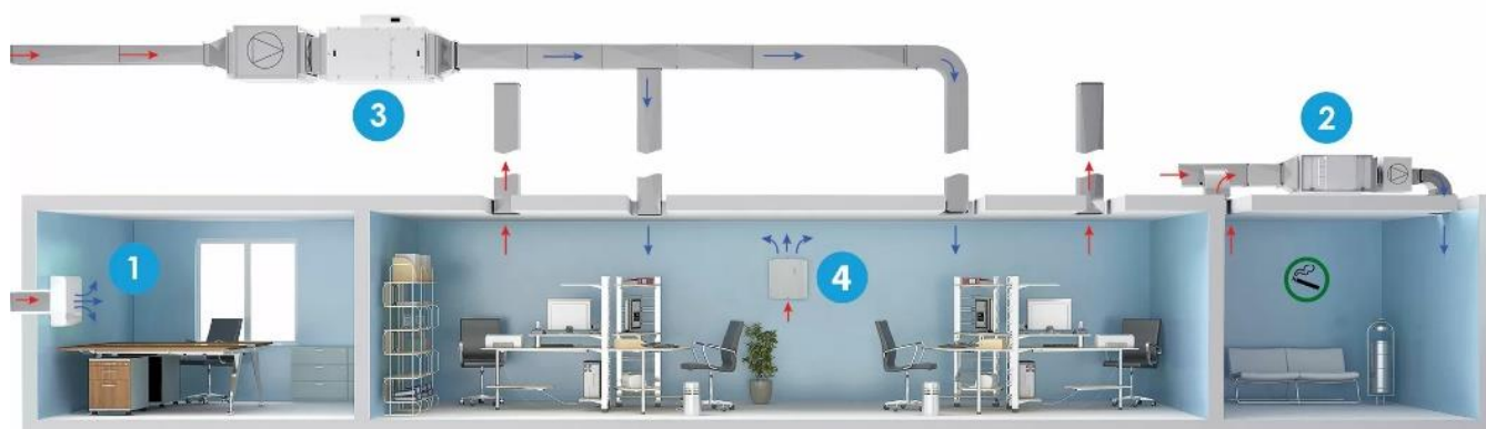
Рисунок 1.5 – Схема організації мікроклімату та вентиляції приміщення
