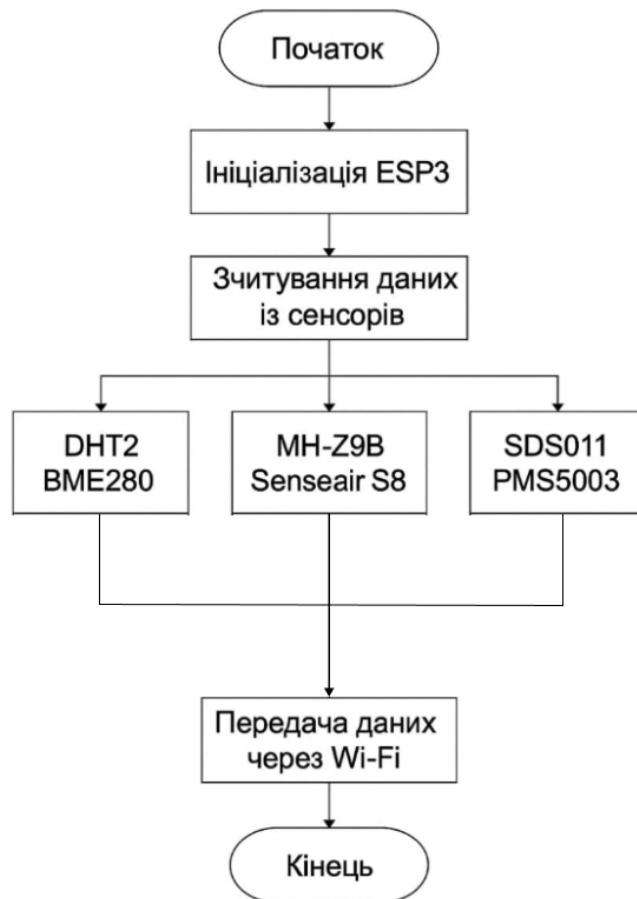
Рисунок 2.13 – Алгоритм роботи системи моніторингу якості повітря на основі IoT
