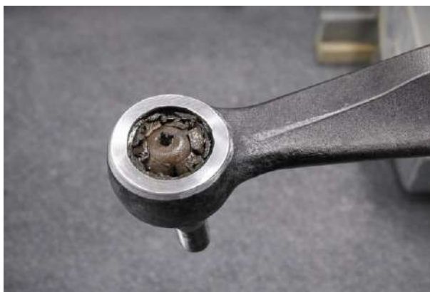
Рисунок 3.1 – Розбірний спосіб ремонту шарових опор
