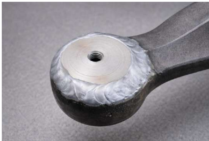
Рисунок 3.3 – Відновлена шарова опора після ремонту
