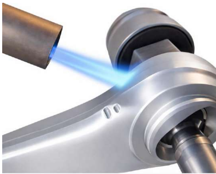
Рисунок 3.6 – Процес термічної підготовки корпусу шарової опори перед заливкою полімерного матеріалу
