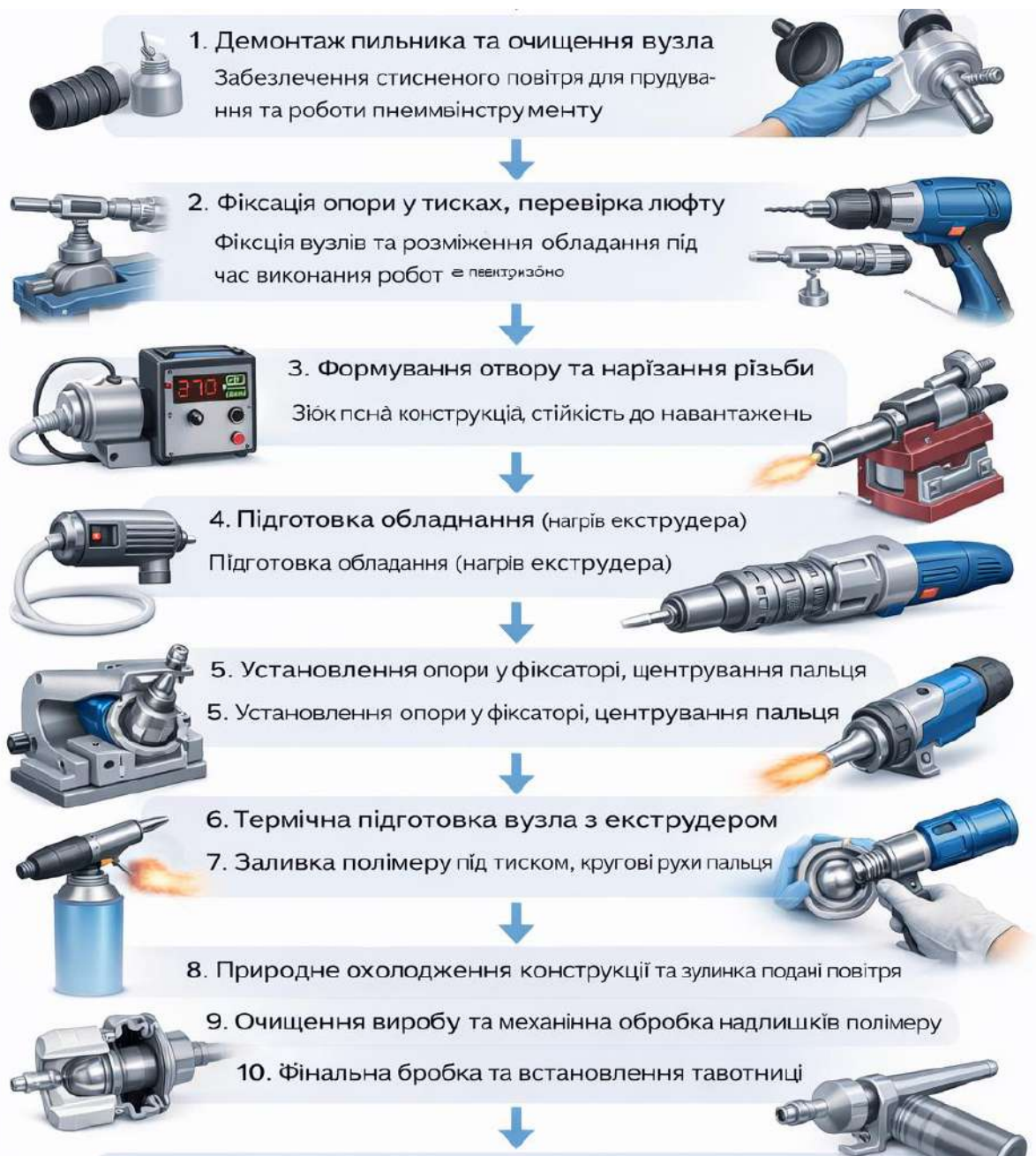
Рисунок 3.10 - Технологічний процес відновлення шарової опори з полімерним антифрикційним шаром
