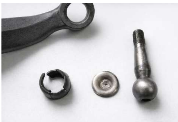
Рисунок 3.2 – Конструкція (структура) шарової опори
