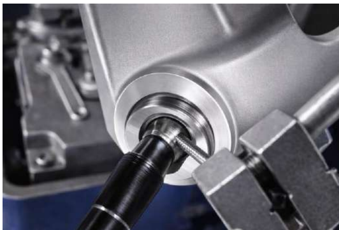
Рисунок 3.6 - свердління отвору з подальшим нарізанням різьби типорозміру М6
