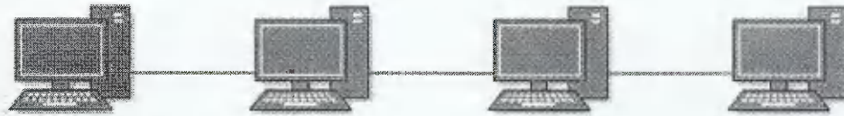
Рисунок 1.5 – Лінійна топологія (Daisy Chain) БКППС[60]
