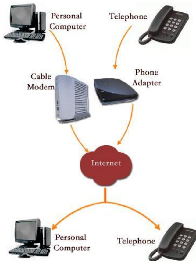
Рисунок 2.9 – Технологія передачі медіа-даних (VoIP-зв'язок) у реальному часі [54]
