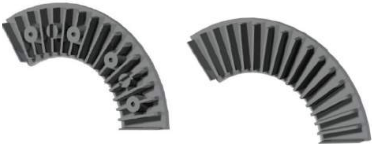
Рисунок 2.24 – Переріз гальмівного диска, що використовується в аналізах, до (ліворуч) та після (праворуч) спрощення.
