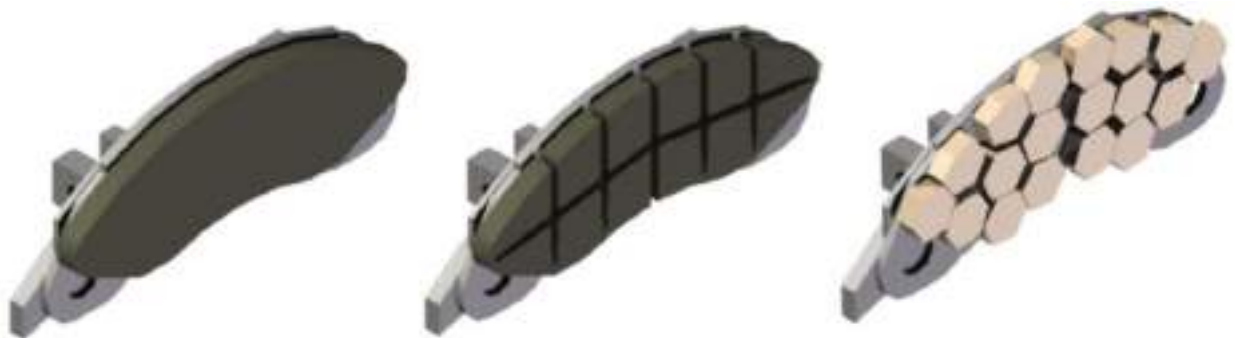
Рисунок 2.19 – Зліва направо: органічне покриття без прорізів, органічне покриття з прорізами та спечене покриття.
