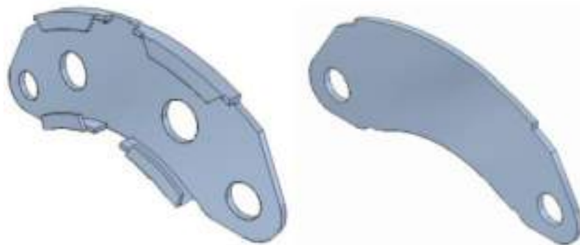
Рисунок 3.23 – Кріплення колодок до (ліворуч) та після (праворуч) спрощення.
