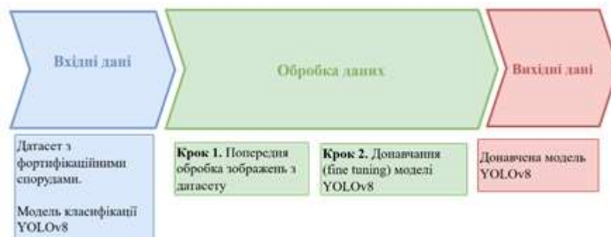
Рисунок 2.4 – Схема методу донавчання моделі YOLOv8 для виявлення фортифікаційних споруд
