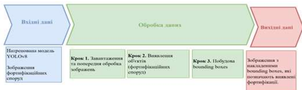
Рисунок 2.5 – Схема використання донавченої моделі для детекції фортифікаційних споруд.
