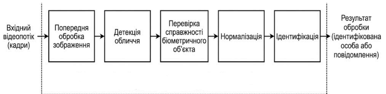
Рисунок 3.1 – Структурна схема конвеєра обробки біометричних даних
