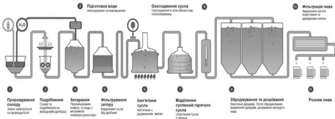
Рисунок 4 – Технологічні операції під час виготовлення кінцевого продукту
