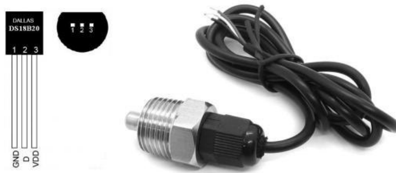
Рисунок 13 – Цифровий температурний сенсор на базі інтегральної схеми DS18B20
