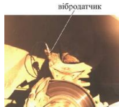
Рис. 9. Схема встановлення вібродатчика на автомобілі ВАЗ 2102
