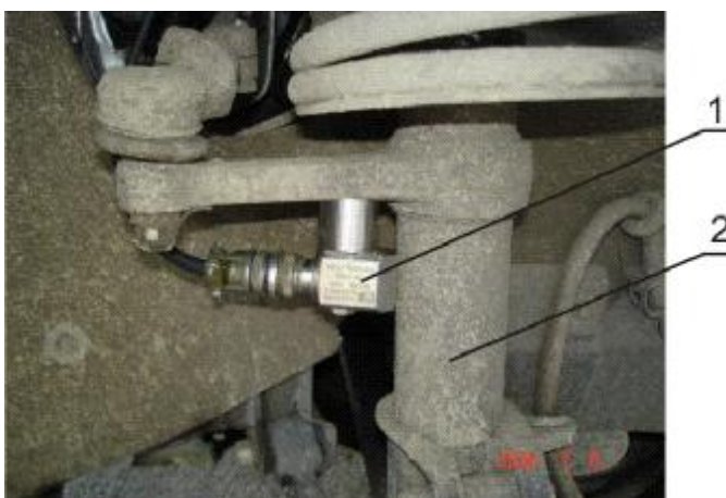
Рис. 13. Схема встановлення вібрдатчика на стійці передньої підвіски автомобіля ВАЗ 2110: 1 – вібрдатчик; 2 – стійка передньої підвіски
