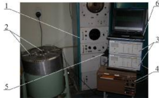
Рис. 6. Стенд для вимірювання і фіксації параметрів вібрацій, змодельований стендом вібраційним ВЭДС-200А: 1 – стенд вібраційний ВЭДС-200А; 2 – акселерометри; 3 – віброметр ПН-19; 4 – осцилограф; 5 – АЦП; 6 – ЕОМ (ноутбук)
