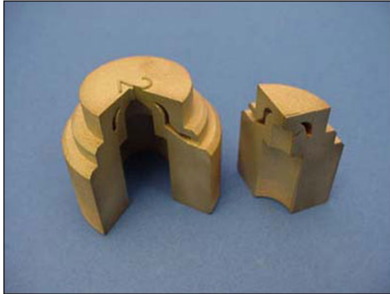
Рисунок 1.6 - Деталь, виготовлена з металу за технологією ProMetal
