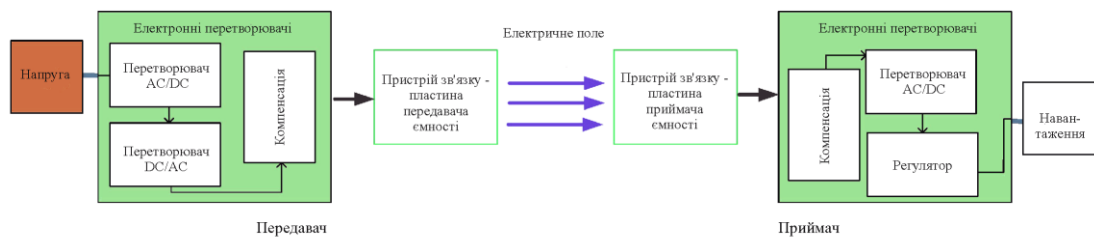
Рисунок 1.5 – Бездротова передача живлення – CPT
