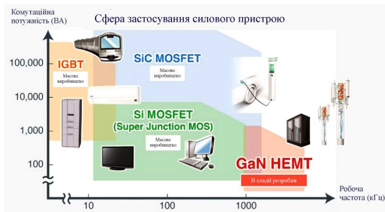
Рисунок 2.2 – Область застосування потужності та частоти для IGBT, SiC MOSFET і GaN HEMT
