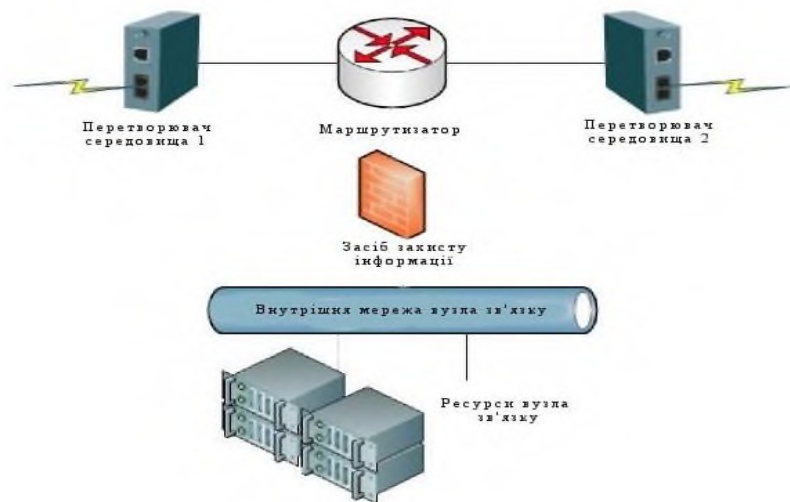
Рисунок 1.5 – Процес обробки мережевого трафіку на вузлі зв'язку
