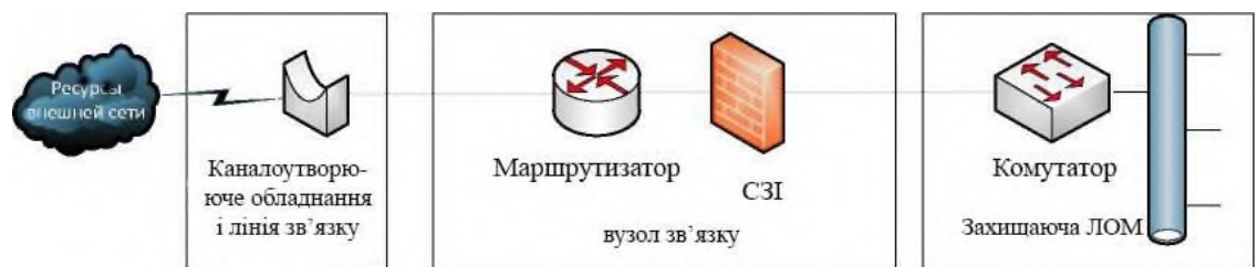
Рисунок 4.1 - Схема розташування вузла зв'язку в корпоративній мережі
