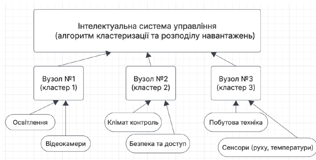
Рисунок 4.1 - Кластеризована мультикомп'ютерна архітектура розподіленого управління ресурсами системи розумного будинку
