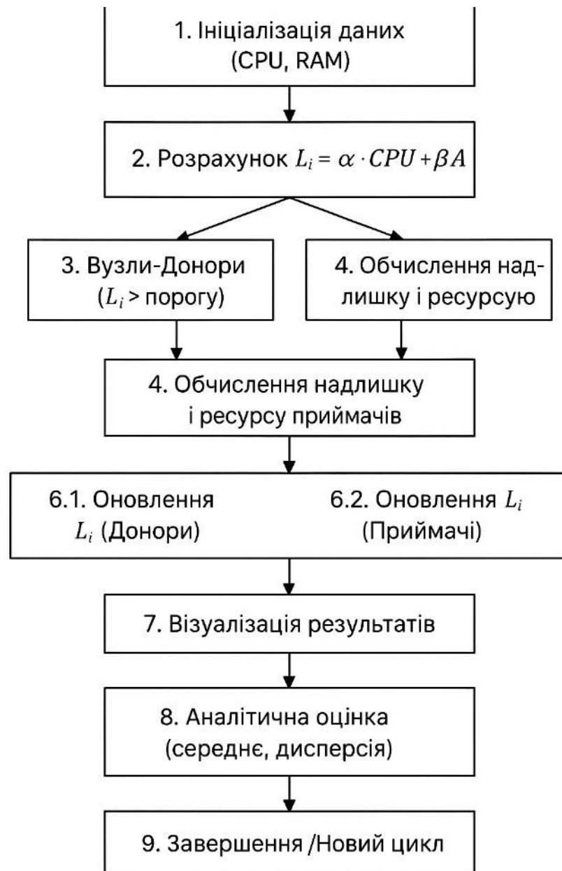
Рисунок 4.3 - Блок-схема алгоритму кластерного розподілу навантаження
