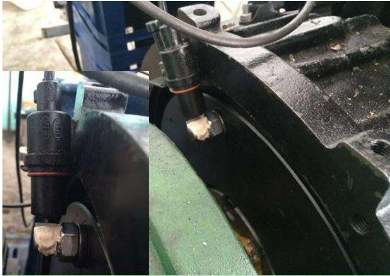
Рисунок 3.10 Розташування датчика положення колінчастого вала
