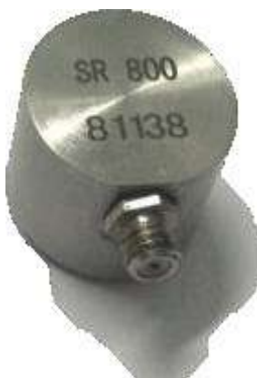
Рисунок 3.4 Датчик акустичної емісії широкого діапазону SR800
