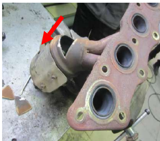
Рисунок 1.9.Каталітичний нейтралізатор з вирізаним фрагментом корпусу
