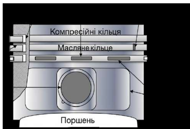
Рисунок 1.1. Геометричні характеристики поршня та кільця
