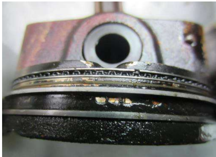
Рисунок 1.8.Стан поверхонь поршнів та кілець двигуна
