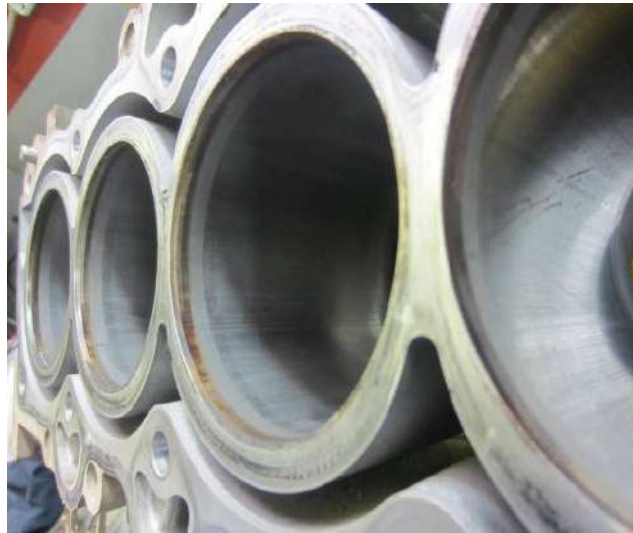
Рисунок 1.7.Знос робочих поверхонь циліндрів двигуна
