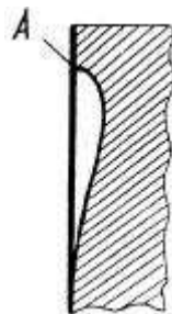
Рисунок 1.4 – Характер зношування дзеркала циліндра ДВЗ.
