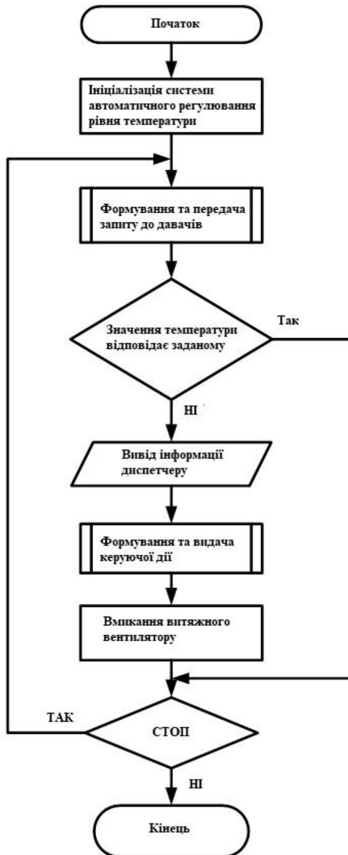
Рисунок 3.16 – Блок-схема алгоритму керування технологічним процесом
