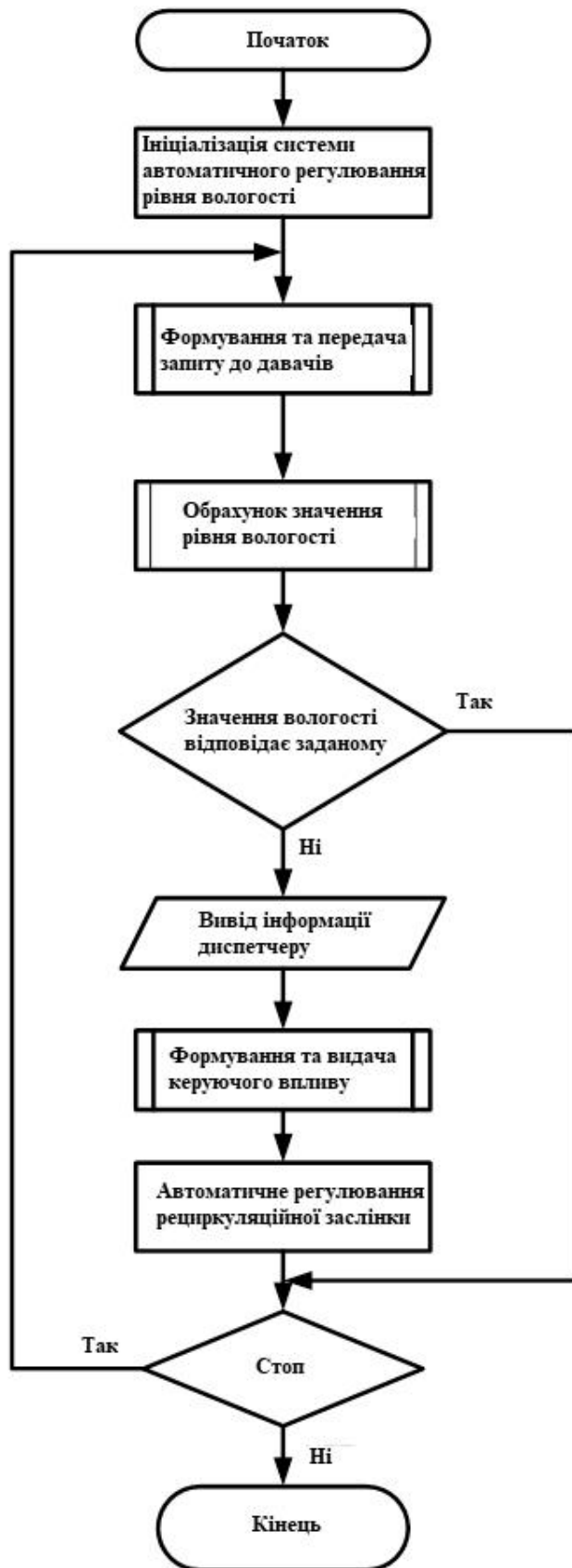
Рисунок 3.17 – Блок-схема алгоритму керування процесом регулювання вологості
