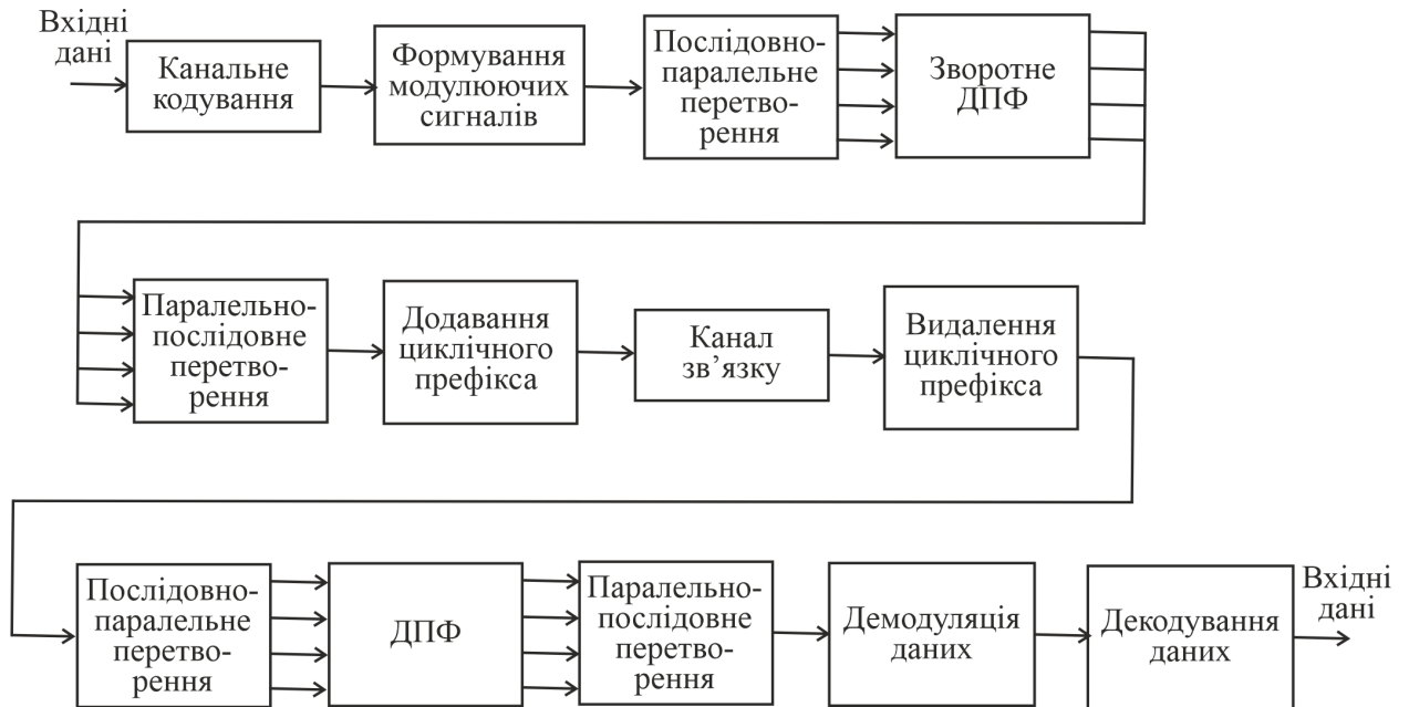
Рисунок 2.7 – Структура радіолінії з сигналами OFDM (ДПФ – дискретне перетворення Фур'є)
