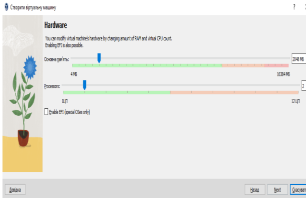
Рисунок 3.4 – Виділення оперативної пам'яті та ядер процесора на віртуальну машину
