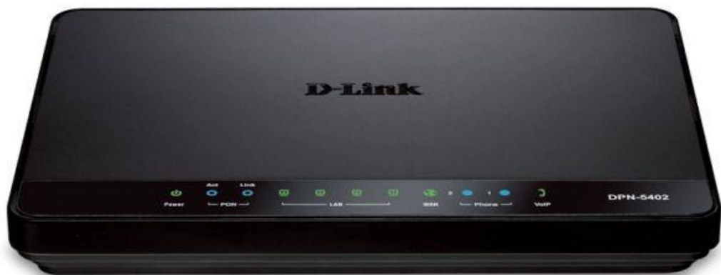
Рисунок 3.14 – Термінальне абонентське обладнання для ITM мікрорайону Озерна міста Хмельницький: DPN-5402 ITM
