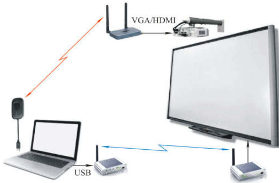
Рисунок 4.20 – Схема безпроводового під'єднання інтерактивної дошки (варіант з адаптерами VGA/HDMI та USB)
