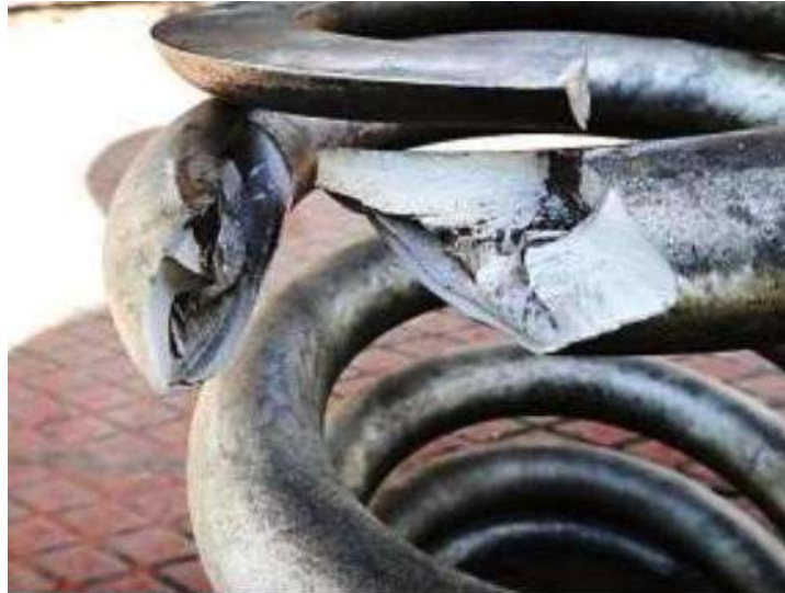
Рис. 3.5 – Втомний злам витків пружини
