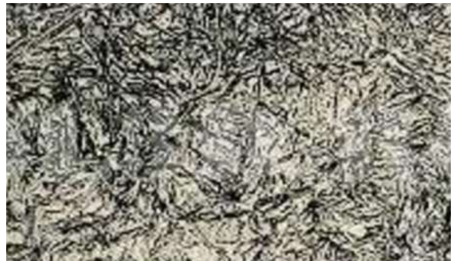
Мікроструктура сталі 60С2ХА після термічної обробки
