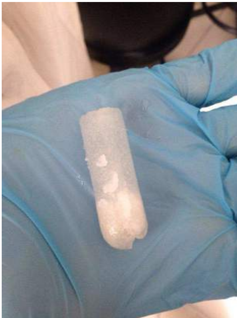
Рисунок 3.4 – Ушкоджений зразок при добуванні, зазначене місце відриву
