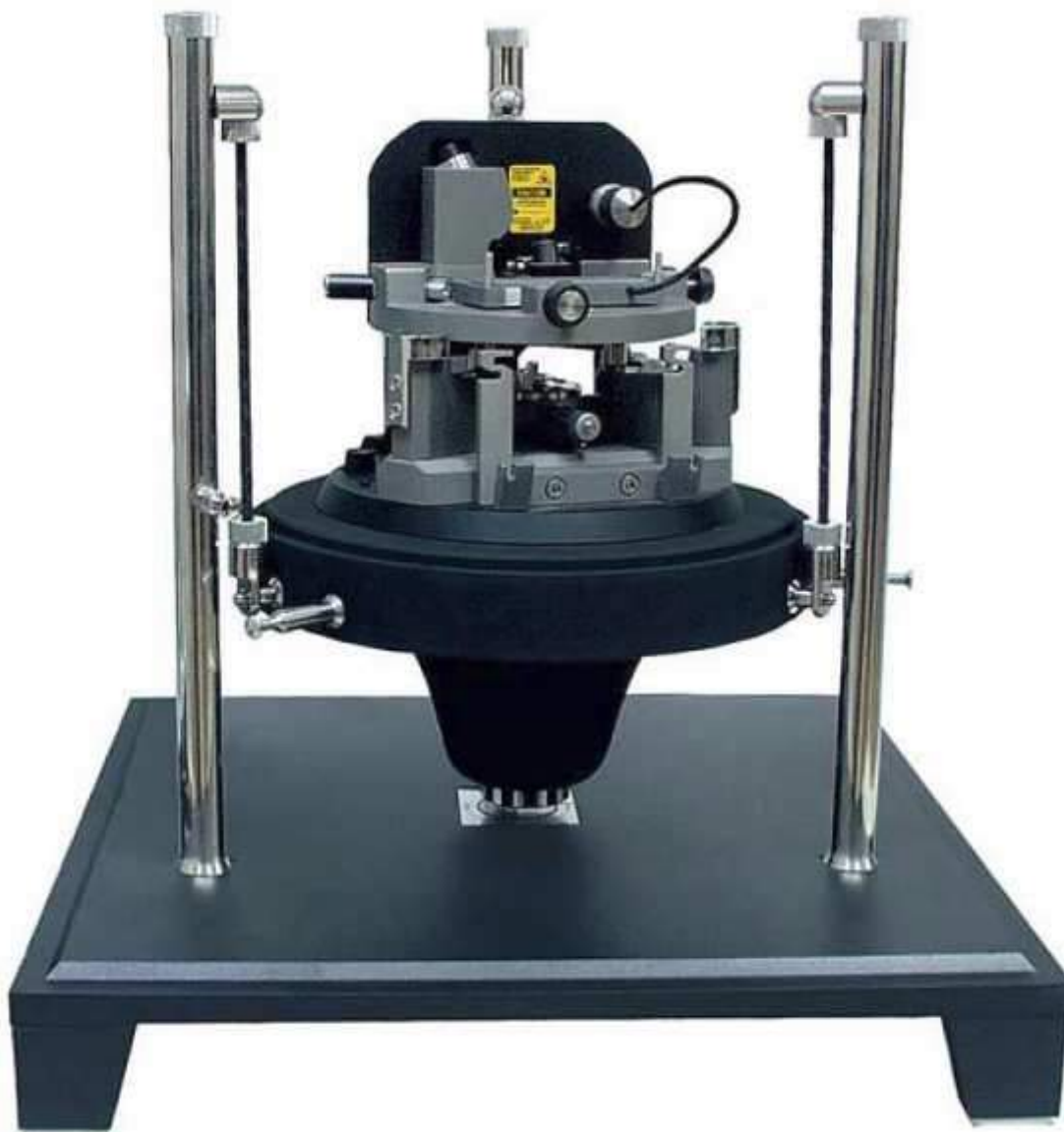
Рисунок 2.4 – Загальний вид мікроскопа Solver P47H
