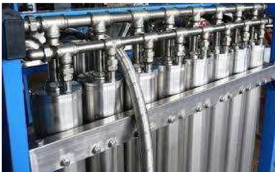
Рисунок 1.6 – Приклад установки з керамічними мембранами
