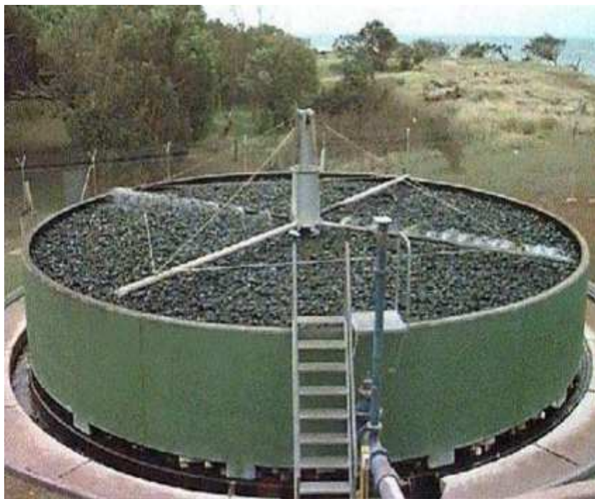
Рисунок 1.4 – Приклад краплинного фільтра
