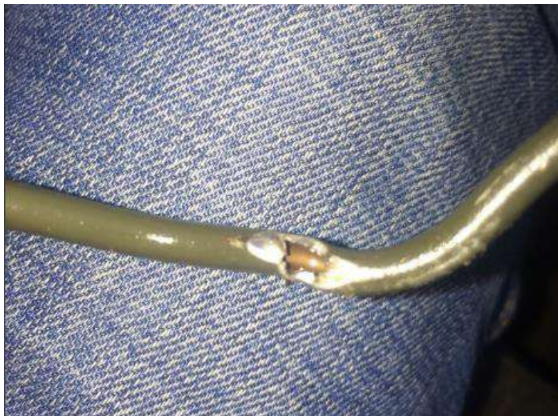
Рисунок 25 – Наслідок перетирання гальмівної трубки
