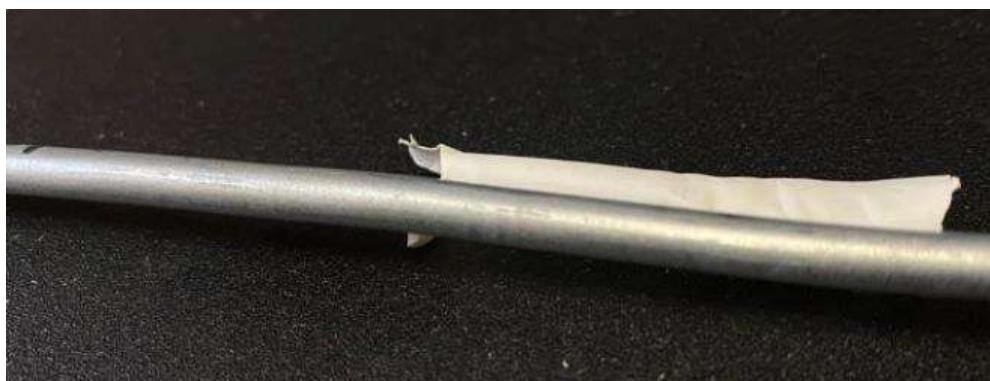
Рисунок 50 – Відсутність слідів зношування на гальмівній трубці
