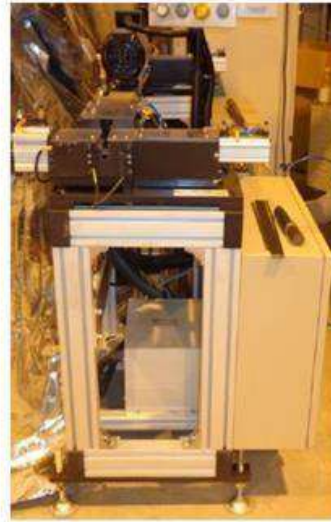
Рисунок 12 – Зняття фасок: а – гальмівна трубка з фаскою; б - спеціальний верстат
