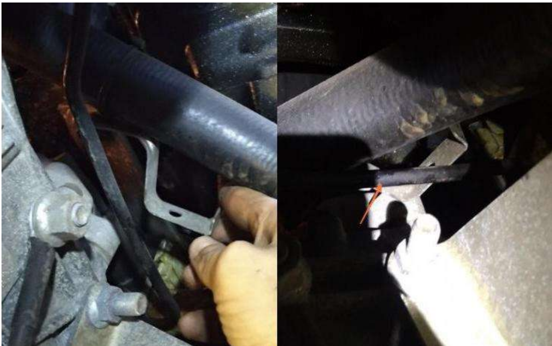
Рисунок 27 – Протирання гальмівних трубок про незакріплений кронштейн
