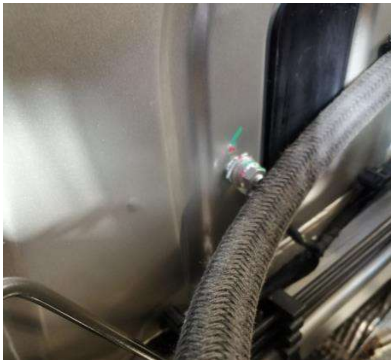
Рисунок 33 – Перетирання шлангу ВУТ про шпильку маси
