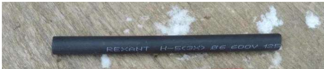
Рисунок 52 – Термоусадка як захисний рукав
