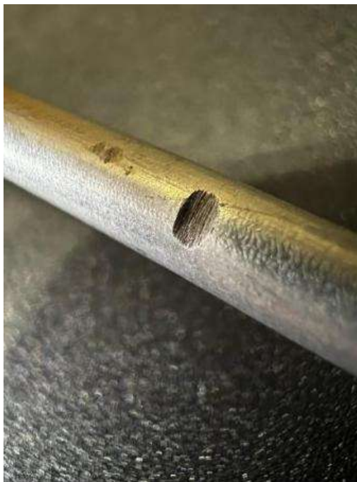
Рисунок 46 – Результат експерименту на стійкість до стирання гальмівної трубки без захисних рукавів
