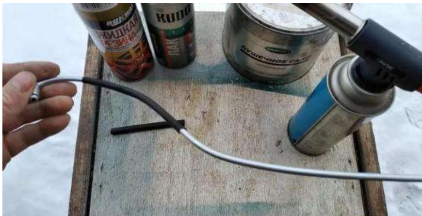
Рисунок 53 – Термоусадка на гальмівній трубці
