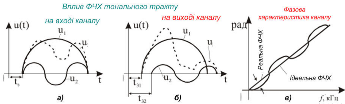
Рисунок 1.9 – Вплив неідеальності фазової характеристики на спотворення
