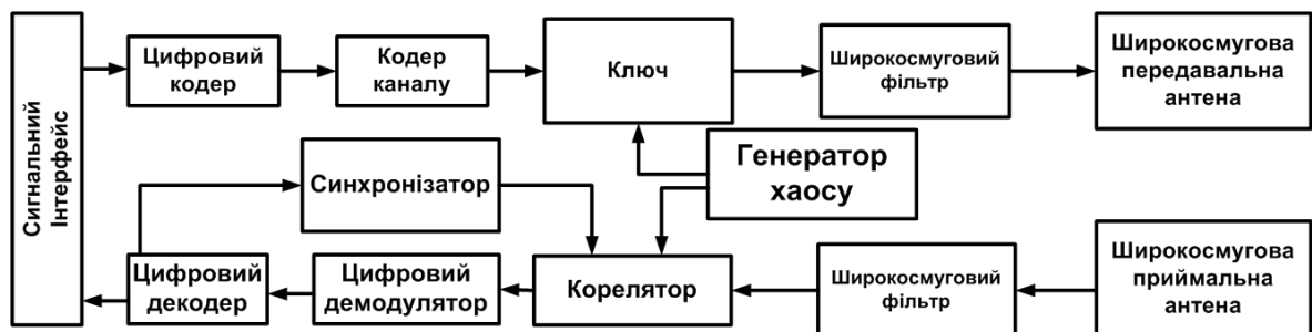
Рисунок А.5 – Прямохаотична імпульсна широкопasmову система зв'язку
