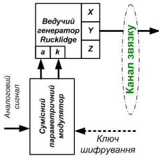
Рисунок 9.1 – Схема параметричної модуляції хаотичного генератора
