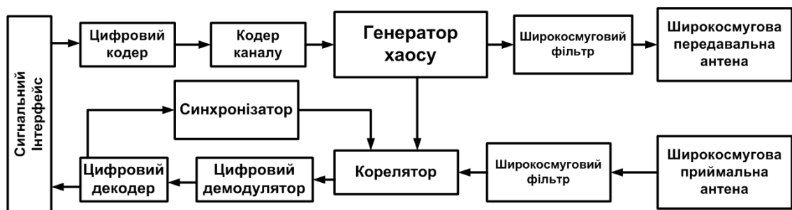
Рисунок А.4 – Система широкопasmової телекомунікації із застосуванням внутрішньої модуляції параметра хаотичного генератора
