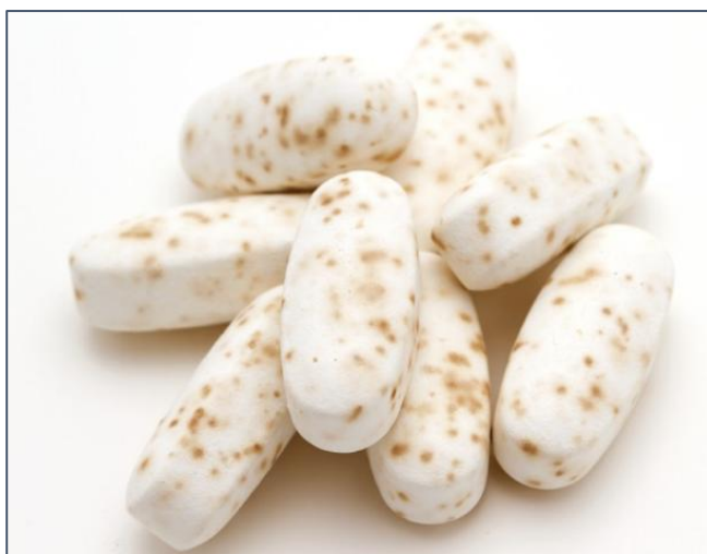
Рисунок 1.1 – Приклади дефектів фармацевтичних пігулок [19]
