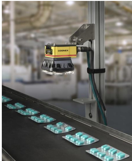
Рисунок 1.4 – Обладнання для аналізу партій Cognex [39]
