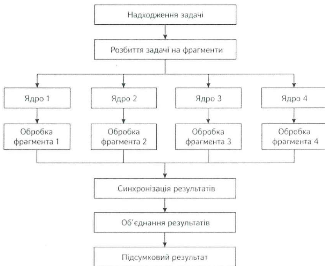
Рисунок 2.4 – Модель паралельного виконання обчислювальної задачі у спеціалізованому багатоядерному процесорі
