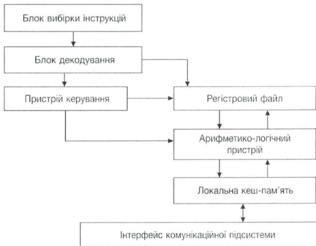
Рисунок 2.3 – Функціональна структура обчислювального ядра спеціалізованого багатоядерного процесора
