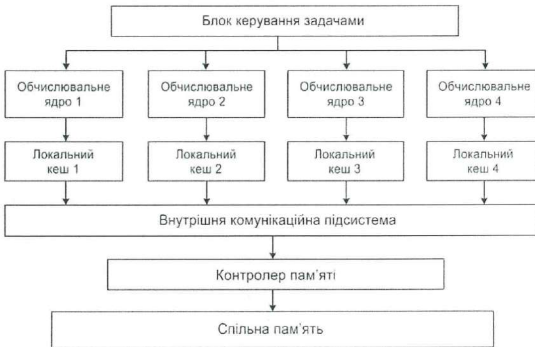
Рисунок 2.1 – Загальна структура спеціалізованого багатоядерного процесора підвищеної продуктивності
