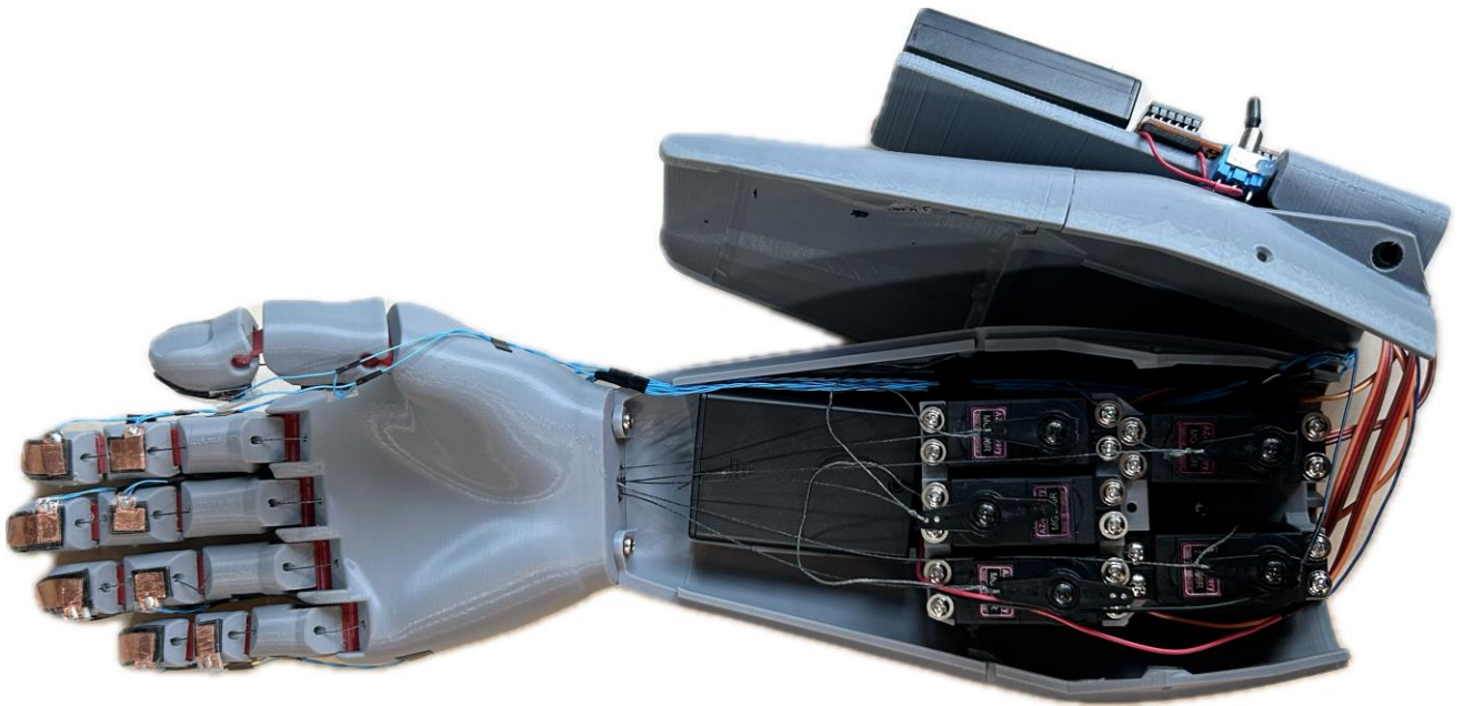
Рисунок 3.8 – Розміщення сервоприводів в РПР
