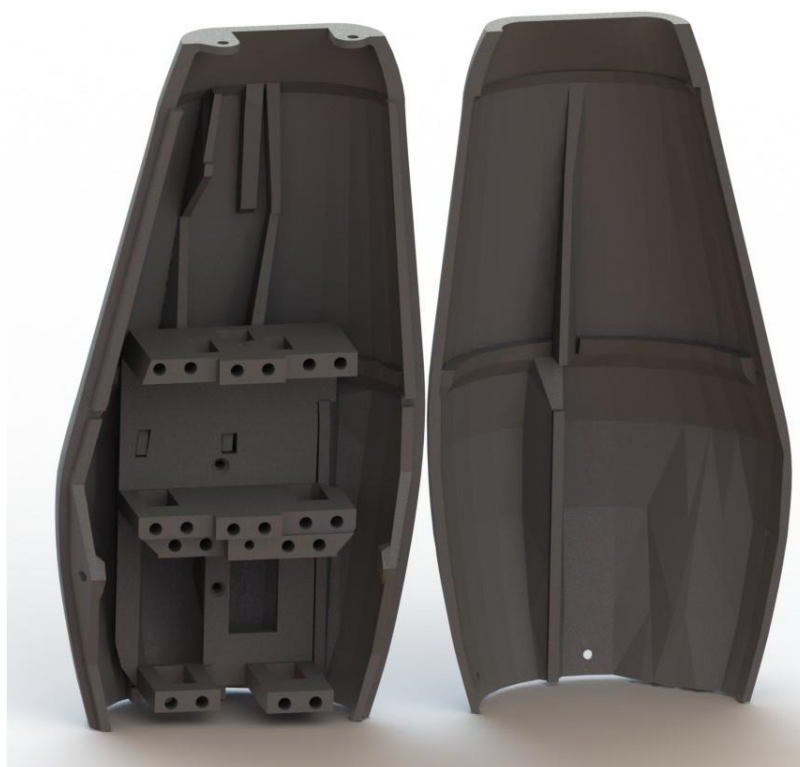
Рисунок 3.2 – Моделі верхньої та нижньої частини руки РПР
