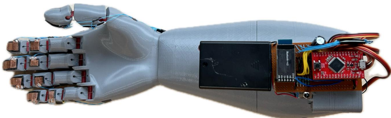
Рисунок 3.7 – Прототип роботизованого протезу руки
