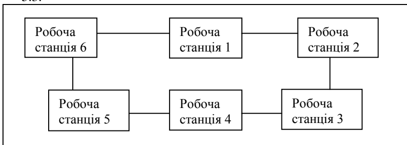
Рис.5.3. Архітектура кільцевої мережі.
