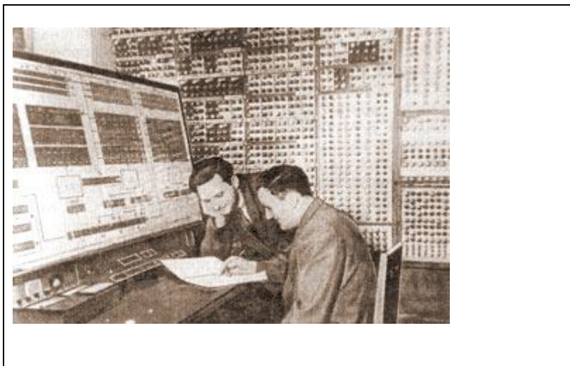
Рис.1.3. Пульта управління та процесор МЕСМ-1.
