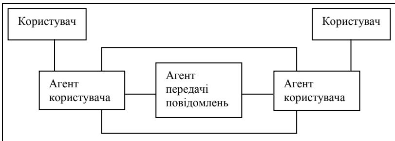
Рис.9.4. Варіант реалізації АПП і двох АК на одному комп'ютері.
