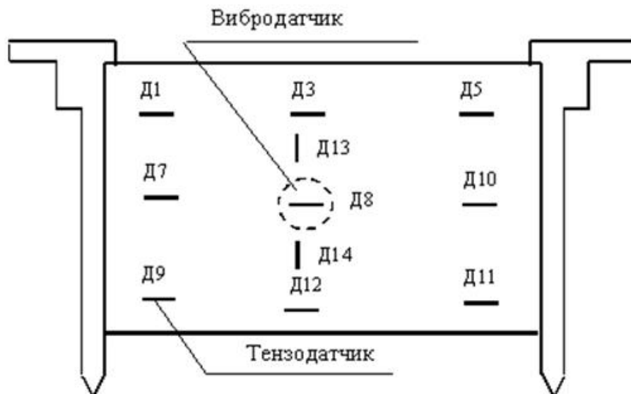
Рис. 1. Обобщенная схема препарировки объединительных плат вибродатчиком и тензодатчиками
