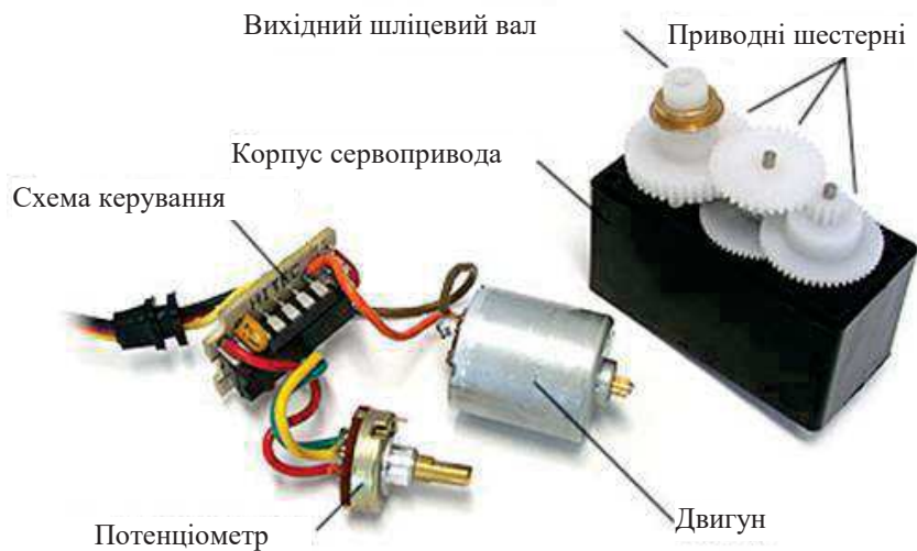
Рисунок 3.6 – Загальний вигляд елементів конструкції сервопривода
