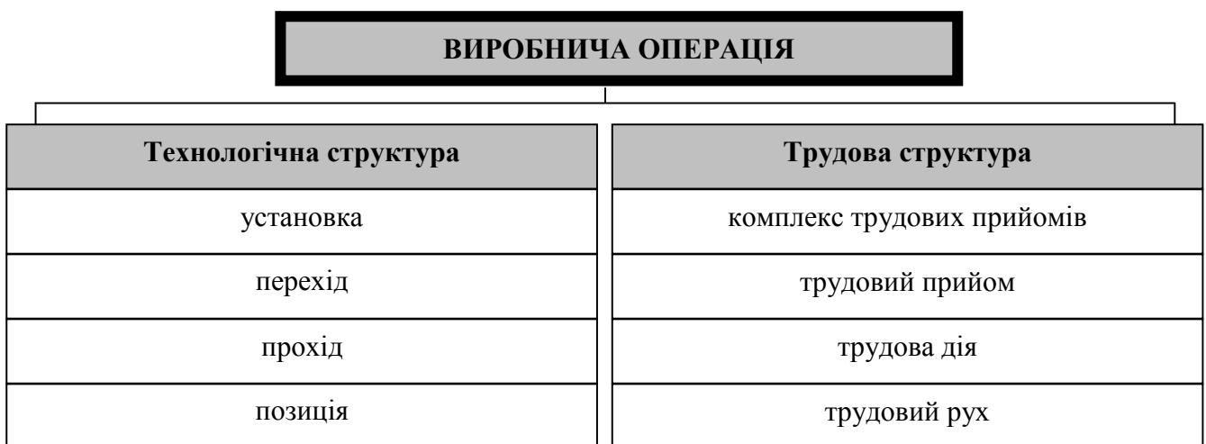
Рис. 25.2. Структура виробничої операції
