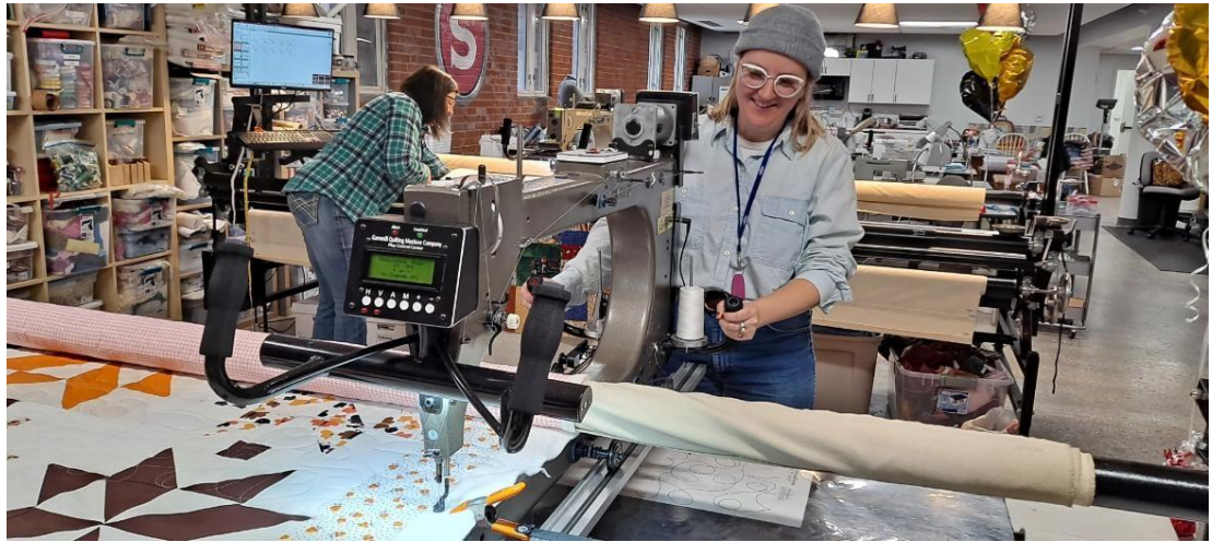
Рисунок 1.8 – Процес виготовлення ковдри в техніці квілінг на спеціальному обладнанні
